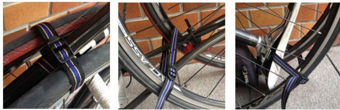
DEMONTRE LA ROUE AVANT, ARRIERE. SANDOICHER ET FIXER AVEC 3 SANGLES
